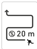
20 m bredd på söksträng (SSB) vid starka externa störningar
