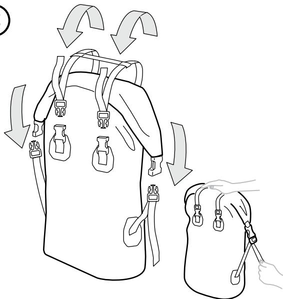
**3. VERBINDEN** Schließen Sie die beiden seitlichen Schnallen und ziehen Sie sie fest nach unten. Ziehen Sie beide oberen Riemen über den gefalteten Verschluss, schließen Sie die Schnalle und ziehen Sie die Riemen fest nach unten.
